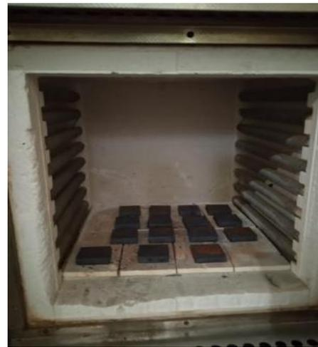
Gambar 10. Proses *annealing* baja JIS SUP 9A
