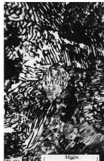
Gambar 4. Struktur mikro perlit halus dengan pembesaran 3000x [12]
