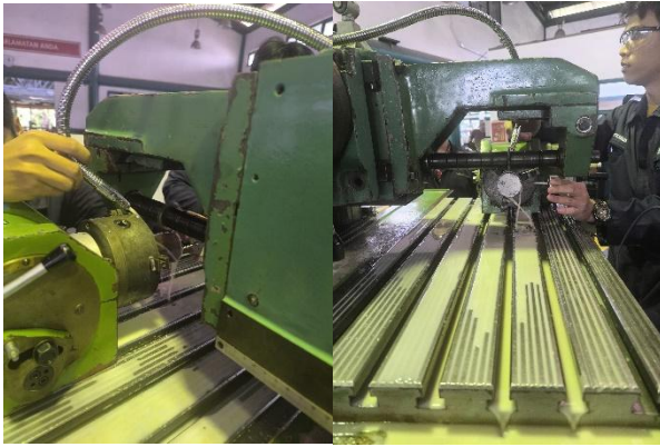
Gambar 6 Proses Pengukuran dengan diameter cutter 20 mm.
