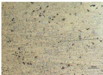
Gambar 6. Struktur Mikro Al-Cu Setelah Proses *Quenching*
