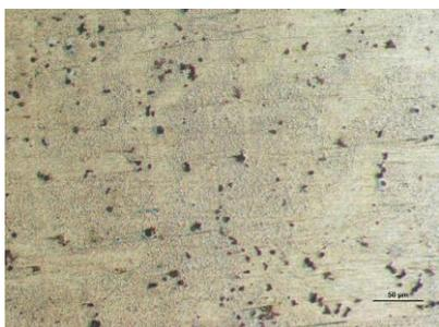
Gambar 7. Struktur Mikro Al-Cu Setelah Proses *Artificial Aging* Pada Temperatur 190°C
