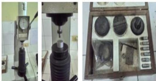
Gambar 3. Alat Uji Kekerasan
