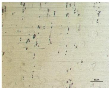
Gambar 5. Struktur Mikro Al-Cu Sebelum Proses Perlakuan Panas (*Raw Material*).
