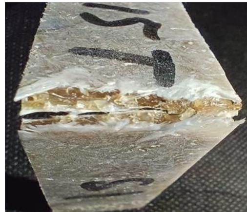
Gambar 11. Variasi 15k:15t Spesimen Uji Tarik
