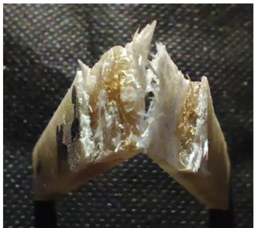
Gambar 15. Variasi 20k:10t Spesimen Uji Bending
