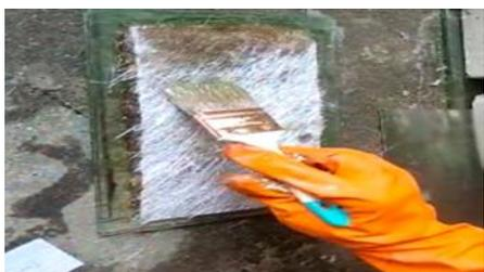
Gambar 2. Proses Pembuatan Komposit
