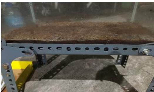
Gambar 1. Perendaman Dengan Larutan NaOH selama 2 jam
