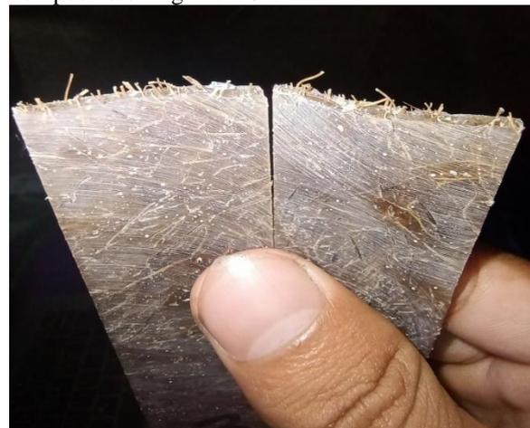
Gambar 3. Foto Makro Bentuk Patahan
