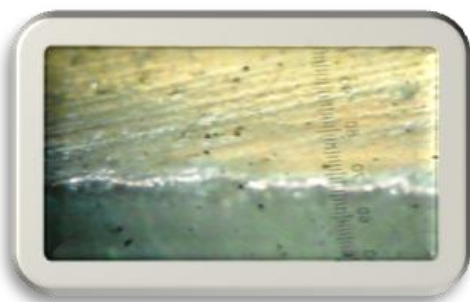
Gambar 5. Lapisan tembaga pada J = 3 \text{ A/dm}^2 , T_e = 50 \text{ }^\circ\text{C}
