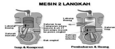
Gambar 1. Siklus Kerja Mesin 2 Langkah (Arends BPM; H Berenschot,1980)
