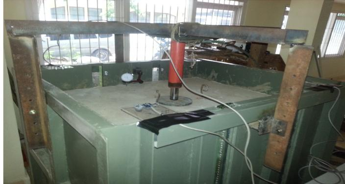
Gambar 1. Bentuk Pemodelan Alat Penurunan Tanah
