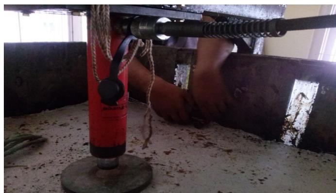
Gambar 5. Pemasangan matras beton bendrat pada boks uji
