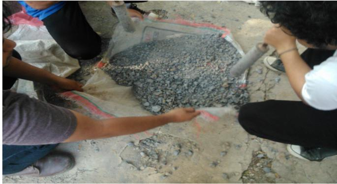
Gambar 3. Penumbukan tanah yang akan diuji
