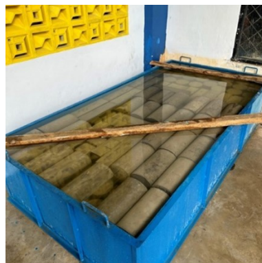
Gambar 2. Proses perendaman benda uji
