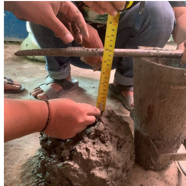
Gambar 1. Pengujian nilai slump
