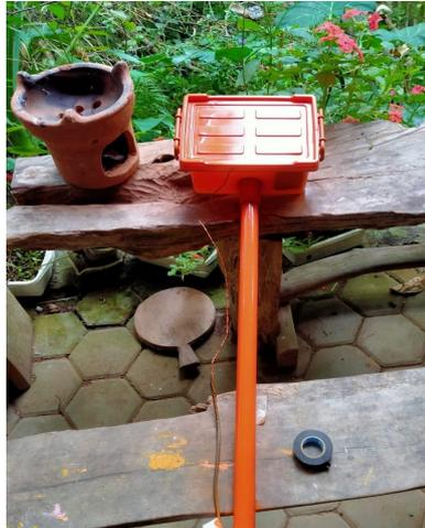
Gambar 3. Alat ukur sedimen tersuspensi berbasis *Turbidity Sensor* (NTU-18).
