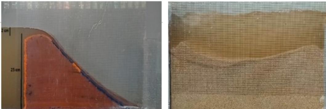
Gambar 2. Gerusan lokal pada kondisi ketinggian air di hulu 2 cm pada Ogee Spillway .
