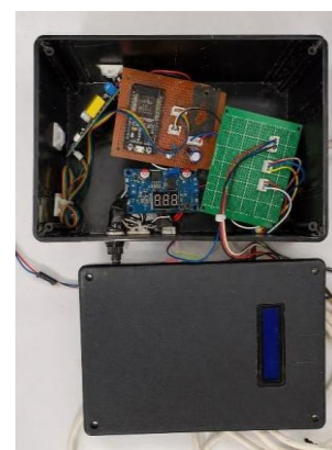
Figure 3. Sistem Pemantauan Berbasis IoT Terpasang di Kandang Ayam
