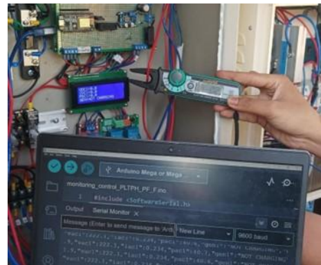
Gambar 8. Uji Akurasi Sensor PZEM-004T dengan Multimeter
