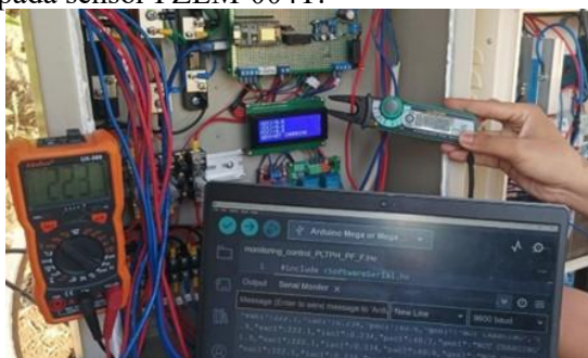
Gambar 7. Uji Akurasi Sensor PZEM-004T dengan Multimeter
