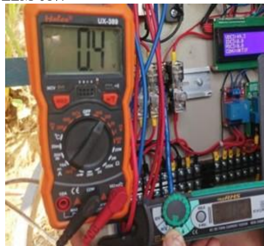
Gambar 6. Uji Akurasi Sensor PZEM-017 dengan Multimeter
