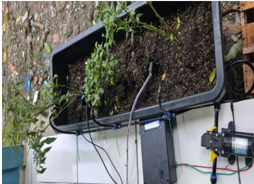
Gambar 2. Implementasi sistem irigasi otomatis pada media tanam
