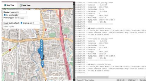
Gambar 13. Pengujian Jangkauan LoRa
