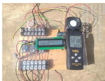
Gambar 14. Pengujian Sensor LDR Dengan Cahaya Matahari
