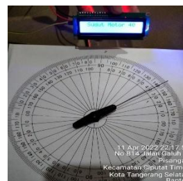
Gambar 15. Pengujian Motor servo Dengan Busur
