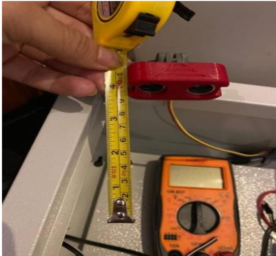
Gambar 4. 5 Pengujian Pengukuran Jarak Ultrasonik
