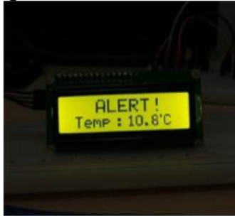
Gambar 18. Tampilan LCD Monitoring Suhu pada Kondisi Tidak Normal (10,8 °C).
