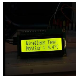
Gambar 17 Tampilan LCD Monitoring Suhu pada Kondisi Normal (4,4 °C).
