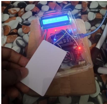
Gambar 4. Proses Pemindaian Kartu RFID pada Sistem Presensi
