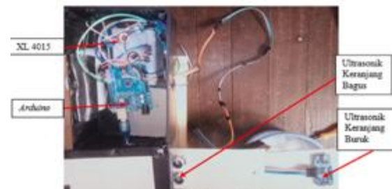
Gambar 3 Implementasi Sistem Pendeteksi Telur Ayam Menggunakan Sensor Ultrasonik
