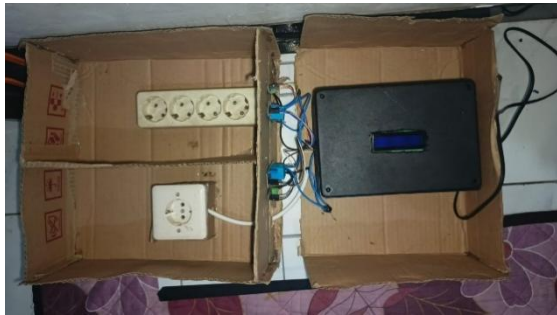
Gambar 6. Implementasi perangkat keras sistem Smart Energy Monitoring (Bagian Luar Sistem)
