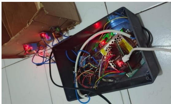
Gambar 7. Implementasi perangkat keras sistem Smart Energy Monitoring (Bagian Dalam Sistem)
