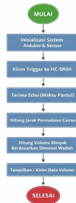
Flowchart sistem digunakan untuk menggambarkan alur kerja sistem pengukuran volume minyak goreng berbasis Arduino Uno dan sensor ultrasonik HC-SR04. Proses dimulai dari inisialisasi sistem, pembacaan jarak
