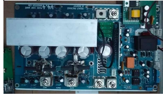
Gambar 5 Hasil Perakitan dan Perancangan Sistem Inverter
