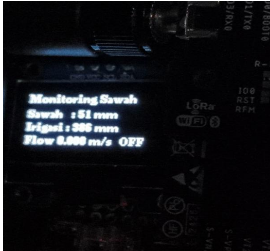
Gambar 2. Hasil Pengukuran Sistem Yang Dirancang
