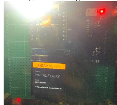
Gambar 4.3 Tampilan Output Kamera dan Status User yang sudah melakukan absensi pada Layar TFT
