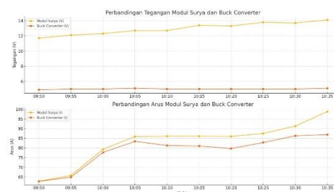
Gambar 4 Grafik Pengujian Menggunakan 1 Modul Surya
