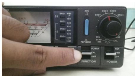
Gambar 11. Kalibrasi VSWR Meter
