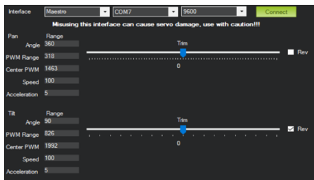
Gambar 10. Konfigurasi Sinyal PWM pada Mission Planner
