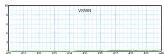
Gambar 4. Simulasi VSWR Menggunakan YagiCAD
