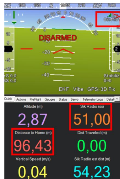
Gambar 19. Data dari Mission Planner (Antena Yagi Rancangan)
