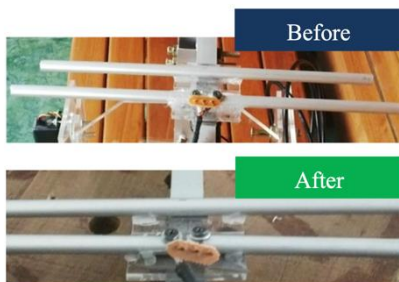
Gambar 6. Perbandingan Konfigurasi Antena Sebelum dan Sesudah Penyempurnaan Jarak Elemen Driven dan Matching
