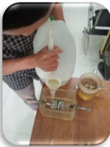
Gambar 16. Pengisian Minyak Trafo Nynas
