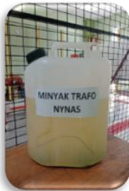
Gambar 9. Minyak Trafo Nynas
