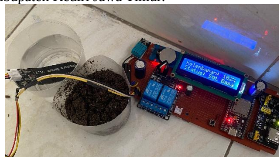
Gambar 4. Proses Pengukuran Kelembapan Tanah.
