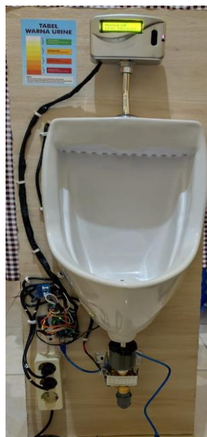
Gambar 12. Sistem Alat Pengecekan Warna Urine di Urinor
