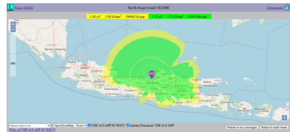
Gambar 2 Hasil Pancaran VHF A/G Approach Control dengan daya pancar 80 Watt menggunakan Radio Mobile
