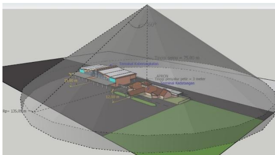
Gambar 14 Pengujian gambar 3D radius proteksi rancangan penyalur petir
