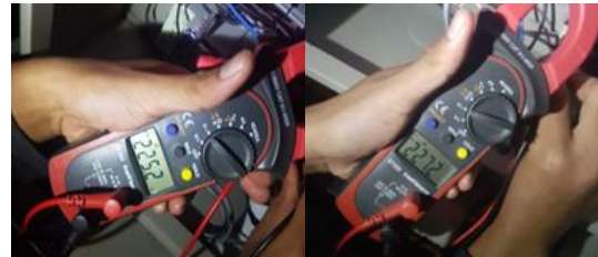
Gambar 25. Pengujian Tegangan PLN.
