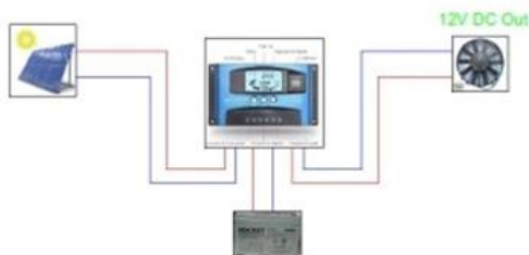
Gambar 3. Rangkaian PLTS Sebelum.
