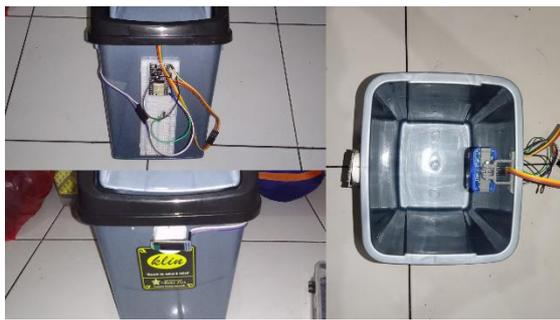
**Gambar 6.** Rangkaian Alat pada Tempat Sampah
