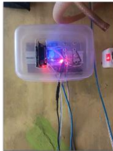
Gambar 14. Sistem dengan mikrokontroler ESP32 ditempatkan di dalam sebuah kotak plastik
