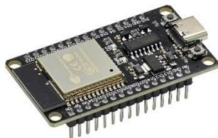
Gambar 1. Mikrokontoler ESP-32.
