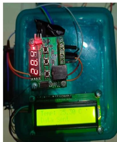
Gambar 9. Display monitoring DHT11 dan DS18B20
