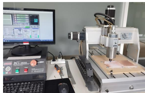
Gambar 10. Proses pembuatan PCB
