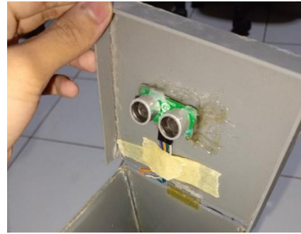
Gambar 21 Hasil pemasangan HC-SR04.
