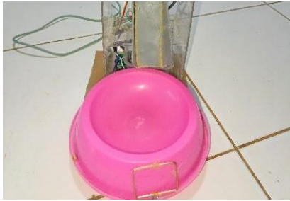
Gambar 19 Hasil Pemasangan RDM6300.
