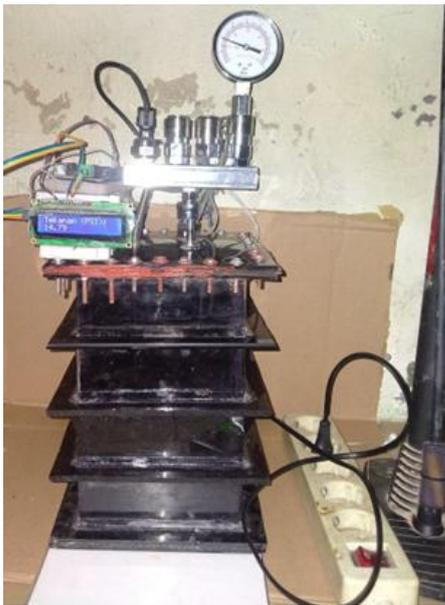
Gambar 4 Tampilan saat pengujian sensor tekanan HK1100C
