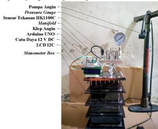
Gambar 2 Tampilan hasil rangkaian pengujian sensor tekanan HK1100C
