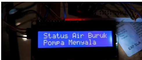
Gambar 4. 3 Hasil Pembacaan Pompa Ketika Menyala
