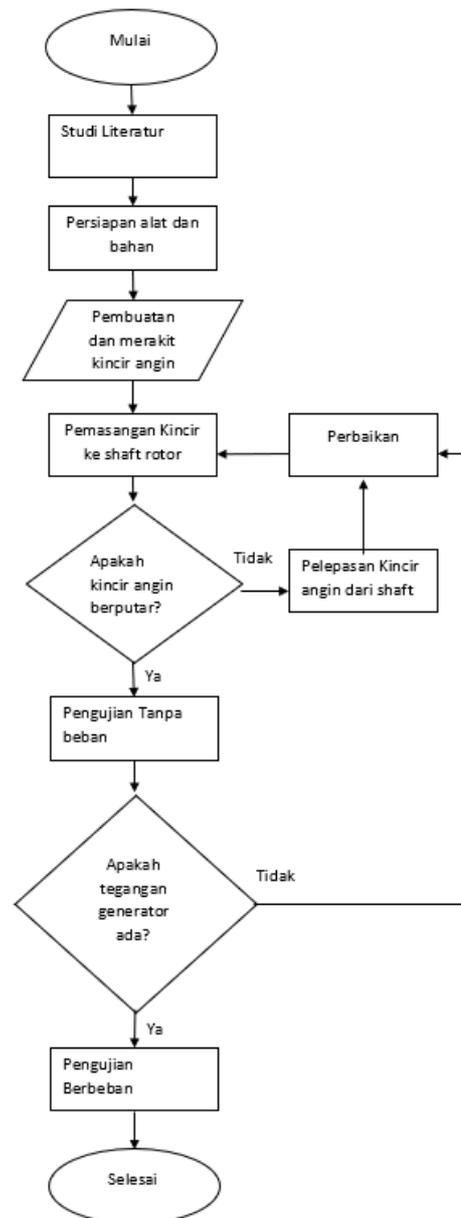
Gambar 3 Alur pembuatan prototipe PLTB skala kecil
