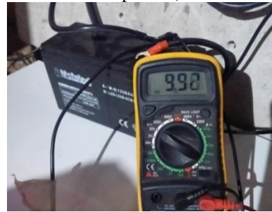
Gambar 18 Akhir pengukuran baterai hingga habis menampilkan 9,92V.
