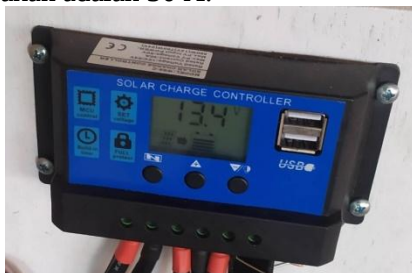
Gambar 10 Menggunakan charger controller dengan arus maksimal 30A.
