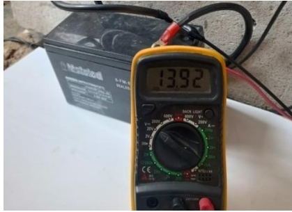
Gambar 17 Hasil akhir pengukuran charging baterai menunjukkan 13,92V.
