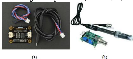
Gambar 4 Sensor yang digunakan; a) TDS meter, b) pH meter.
