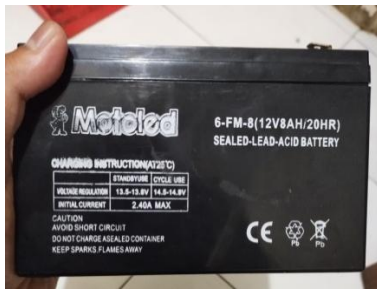
Gambar 9 Baterai yang digunakan bermerk Motoled jenis 12V SLA 8Ah.
