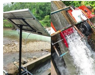
Gambar 4.4 Pengujian Pembangkit Listrik Sistem Hybrid secara Keseluruhan
