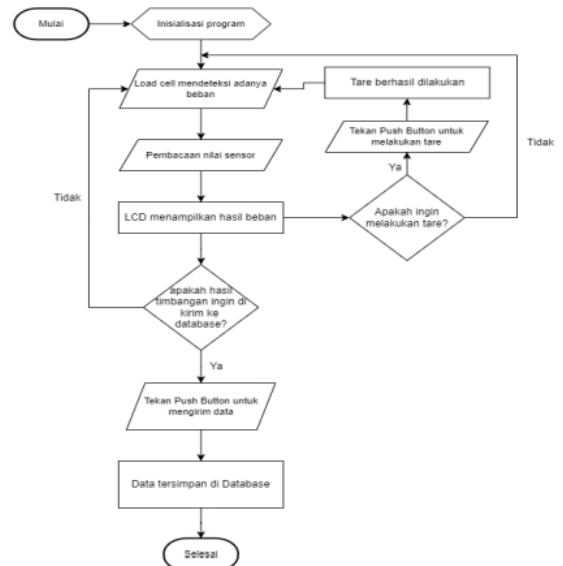
Gambar 6 Flowchart alur kerja alat Flowchart alur kerja alat dimulai dengan inisialisasi program pada timbangan. Setelah benda diletakkan, load cell mendeteksi beban, yang kemudian dikonversi menjadi angka oleh modul HX711 dan ditampilkan pada LCD. Jika hasil timbangan ingin diunggah, tekan tombol push button untuk mengirim data ke aplikasi Spreadsheet. Untuk melakukan tare dan mereset nilai berat, tekan tombol reset.
