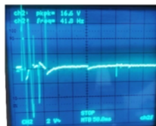
Gambar 4.4. Gelombang tegangan keset piezoelektrik pada osiloskop.
