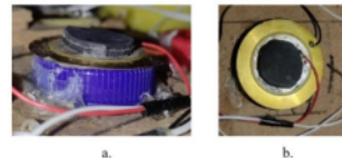
Gambar 4.1. Tampak samping (a), dan atas (b), pemasangan Piezoelektrik .
