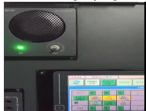
Gambar 14 Melakukan Test Voice dari VCCS JATSC menuju Padang
