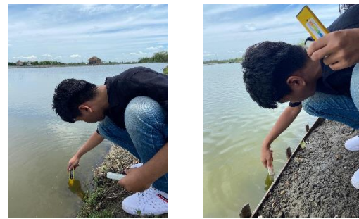
(a) (b) Gambar 14 Pengujian menggunakan alat pabrikan, (a) pH meter, (b) TDS meter (mengukur TDS dan Suhu)
