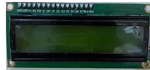
Gambar 5 LCD dot matrik 16x2
