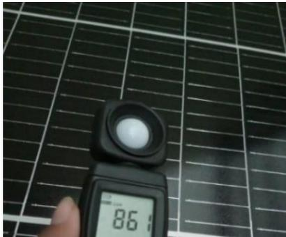
**Gambar 7** Pengukuran Intensitas Cahaya Matahari
