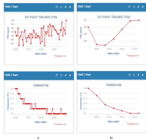
Gambar 12. Grafik Pengujian Air Kopi Dengan Sensor TDS Dan Sensor Temperatur A. Gambar Grafik Keseluruhan Dengan Interval Satu Menit Selama Satu Jam Dan B. Gambar Rata-Rata Selama 10 Menit
